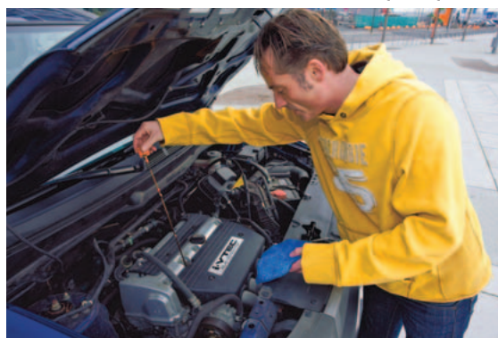
Jokių rūpesčių – 163 AG, 2,4 l keturių cilindų variklis vidutiniškai sunaudoja apie dešimt litrų benzino 100 km
