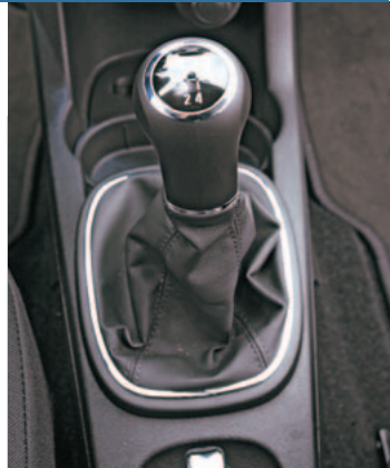
Benzininė Corsa turi penkių o dyzelinė – šešių bėgių mechaninę greičių dėžę
