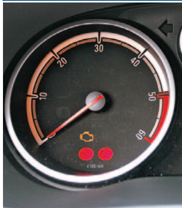
Dyzelinė Opel Corsa geriausiai traukia pasiekusi nuo 2000 iki 4200 aps./min. intervalą
