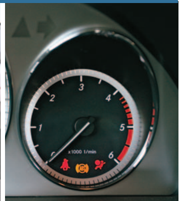
Automatas aukštesnę pavarą perjungia esant 4200 aps./min. Sūkių “dugnas” pasiekiamas esant 5000 aps./min.
