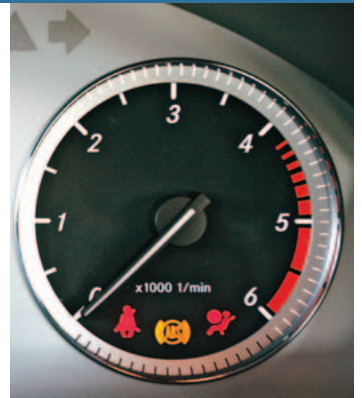
Dyzelinis C klasės Mercedes motoras maksimalų 400 Nm sukimo momentą pasiekia jau esant 2000 aps./min.
