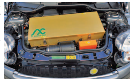
Mini E – išorė kaip įprasto Mini , tačiau po sėdynėmis bei variklio dangčiu slepiasi ateities technologija
