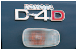
Vietoje penkerių durų yra ir trumpesnė trejų durų versija. D-4D = dyzelis, keturi cilindrai, tiesioginis įpurškimas
