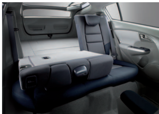
Galinė sėdynė sulankstoma dalimis. Bagažinės tūris jas nulenkus – 408 l, be to, grindyse yra patogi slėptuvė
