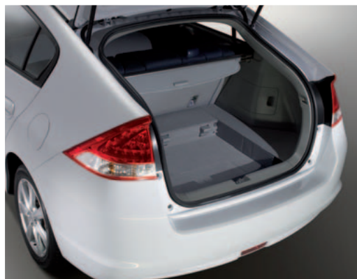
Galinė sėdynė sulankstoma dalimis. Bagažinės tūris jas nulenkus – 408 l, be to, grindyse yra patogi slėptuvė
