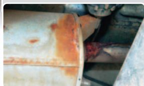
Originalūs duslintuvai laiko neilgai, tačiau didesnių korozijos židinių kitose vietose nepastebėti
