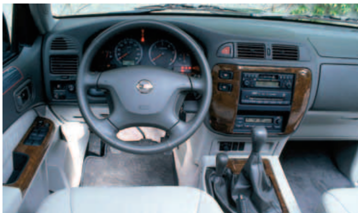
Trumpoji perjungimo svirtelė skirta visiems varantiems ratams ir reduktoriui įjungti. Nuo 2000 m. yra su automatinė pavarų dėže
