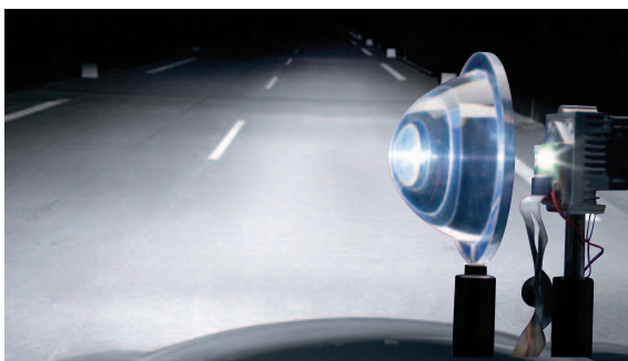
34 LED diodai jau naudojami ne tik posūkių stabdžių žibintuose ir artimosiose šviesose. Jie jau yra ir tolimųjų šviesų žibintuose!
