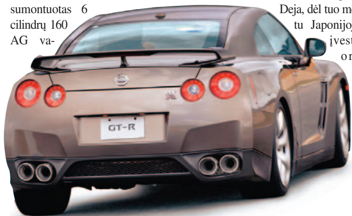
Vadinamasis spoileris skirtas ne GT-R pagražinti, o panaudoti aerodinamines jėgas prispaudžiant automobilio galą
