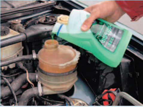
Aušinimo skysčio papildymas gali padėti, bet pikime palaukę, kol variklis atvės
