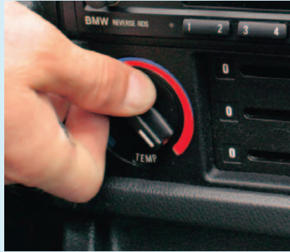
Salono šildymo ir ventiliatoriaus įjungimas šiek tiek padės greičiau atvėsti variklį
