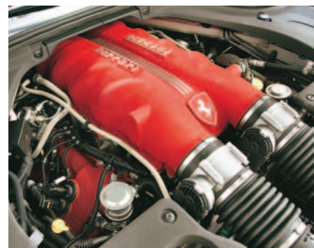
Siekiant geresnio balanso raudonai dažytas V8 variklis įmontuotas toli už priekinės ašies. 460 AG ir pirmą kartą Ferrari istorijoje – tiesioginio degalų įpurškimo sistema
