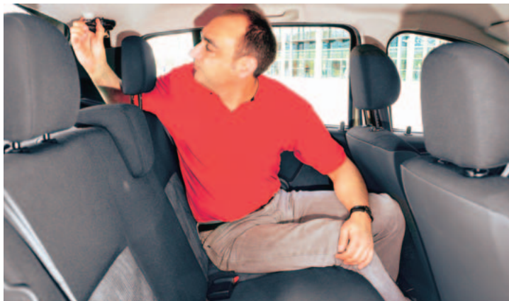
Ant galinės sėdynės vietos nemažai ir kojoms, ir virš galvų. Galinių saugos diržų tvirtinimai sumontuoti ant Sandero lubų
