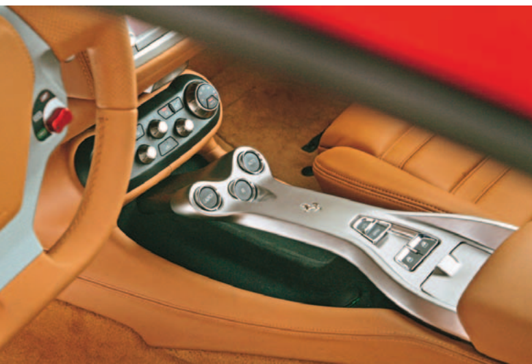
Išlenkta centrinė konsolė: čia nėra pavarų perjungimo svirties, vietoj jos – mygtukai, o greitam startui – "Launch Control" sistema
