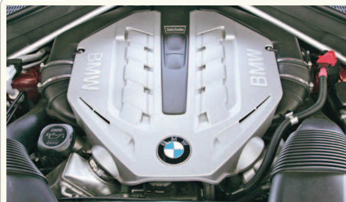
Du turbininiai kompresoriai paslėpti tarp 4,4 l talpos V8 variklio cilindry. Šešių pakopų sportinė automatinė pavarų dėžė persijungia žaibiškai ir beveik nejuntamai
