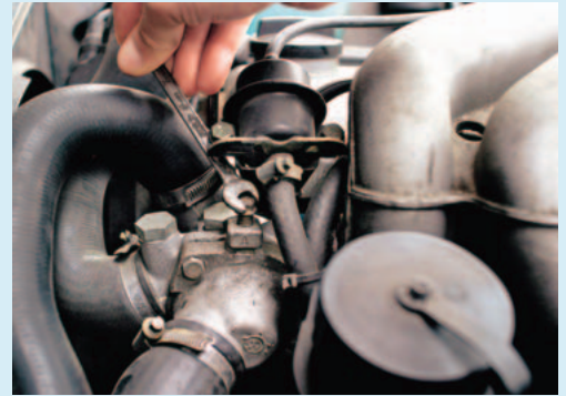
Užvirus aušinimo skysčiui sistemą reikia nurinti. Oro burbuliukai gali trikdyti sistemos darbą
