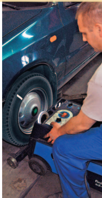
Papildomas balansavimas – tai preciziškas ant mašinos pritvirtinto rato pusiausvyros lyginimas
