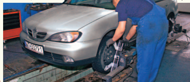
Ratų geometrija. Gerai sureguliuota jų geometrija – tai sąlyga, kad ratai nevibruos ir automobilį taps paprasčiau valdyti. Jeigu ji sureguliuota netinkamai, greitai sudyla padangos
