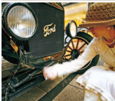
Užvedimo rankeną visuomet reikia sukti į viršų pagal laikrodžio rodyklę, bet negalima persukti laikrodžio skaičiaus 12!
