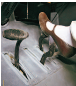
Atsargiai su viduriniu pedalu: šiandienos mašinosse tai stabdys, o ano meto Ford T – atbulinės eigos pedalas
