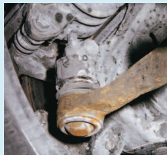
Dėl susidėvėjusių svirties įvorių priekinė pakaba dažnai barška
