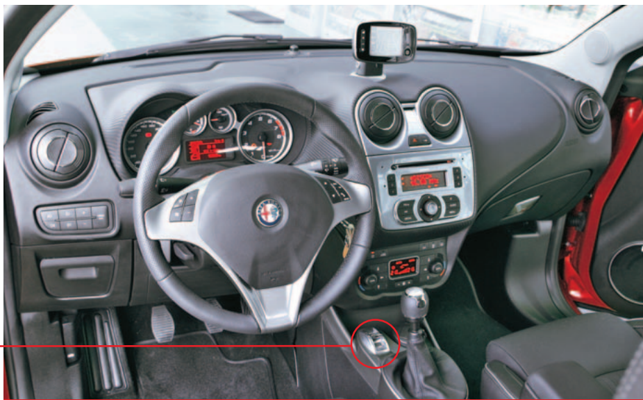
Centrinėje konsolėje šalia pavarų svirties yra trijų režimų jungiklis: „Dynamic“ (geresnė reakcija į akceleratoriaus paspaudimus, ESP su tam tikra slidymo tolerancija), „Normal“ ir „All Weather“ (ESP – didžiausio pasirengimo būsenos). Greičių dėžė standartinė – 6 pavarų
