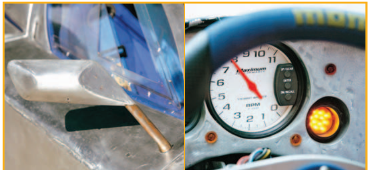
Metalinės detalės greitai rūdija. Išoriniai veidrodėliai trapecijos formos. Gudrybė: geltona švieselė šalia tachometro perspėja, kada perjungti kitą pavarą
