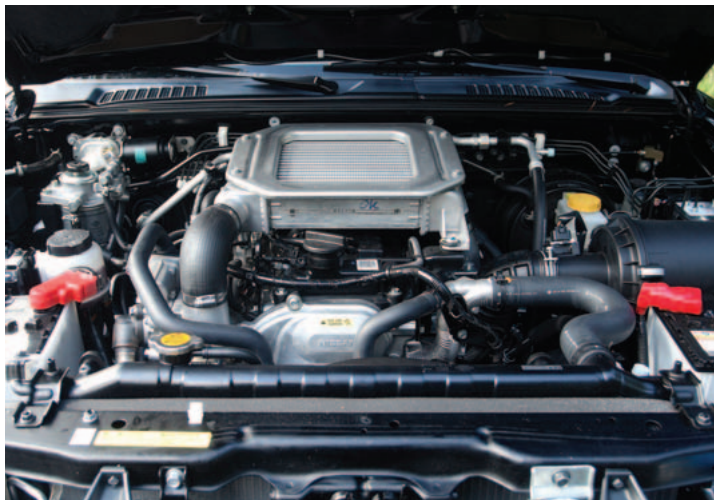
Tai – deforsotas iki 133 AG, 2,5 litro darbinio tūrio 4 cilindrų turbodieselinis variklis, montuojamas Navara modelį (pasiekia 174 AG)
