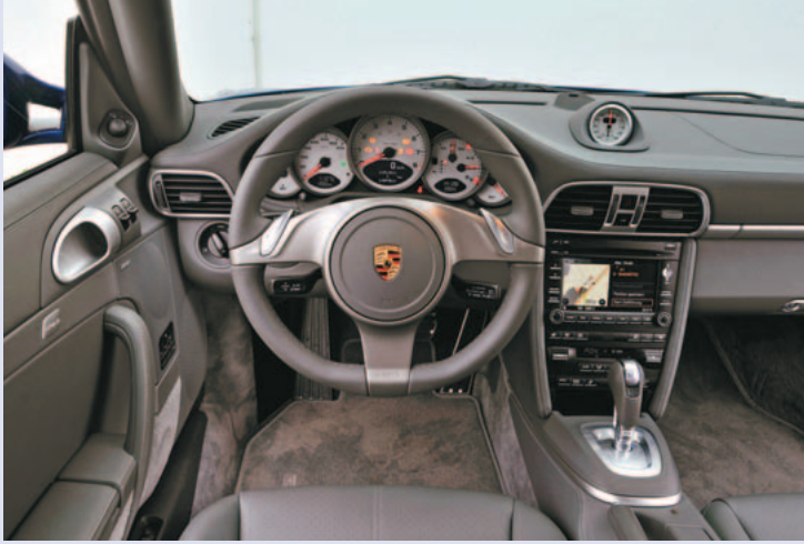
Naujovės “devyni vienuoliktuko” prietaisų skydelyje: didesnis ekranas, nauji jungikliai, modernizuota elektronika
