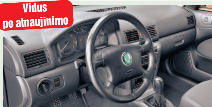
Puiki ergonomika – visi valdymo elementai pasiekiami vos ne intuityviai. Po atnaujinimo gale vietos kojoms padaugėjo 22 mm
