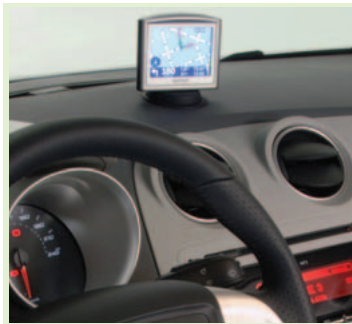
Vietoj brangios navigacinės sistemos "Seat" numatė lizdą "TomTom" navigatoriui įjungti
