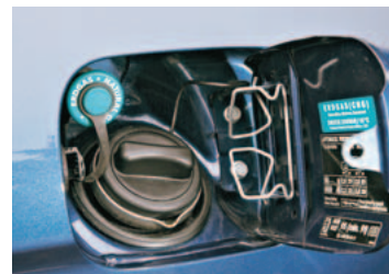
Mercedes automobilio benzino ir dujų bakai įtaisyti vienoje vietoje
