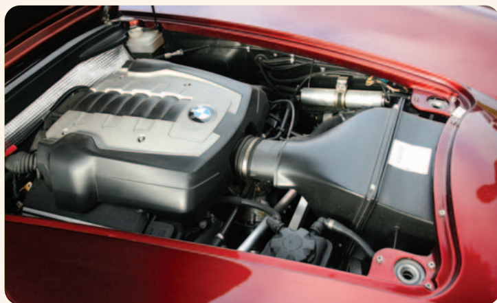
Po variklio dangčiu BMW M5 8 cilindrų, 4.8 l, 367 AG motoras
