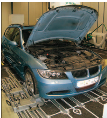
Kokybės pažyma: 320i nuvažiavus 96 556 km, buvo tikrinama jo galia ir išmetamųjų dujų kiekis “Dekros” technologijų centre. Rezultatas: vietoj nurodytų 150 AG keturių cilindrų, 2,0 l tūrio variklis pasiekia tik 146,3 AG – mažokai!
