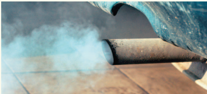
Iš duslintuvų sklindančių dūmų spalva nemažai pasako apie variklio būklę, bet kiekvienąkart tai gali būti skirtingų gedimų priežastis
