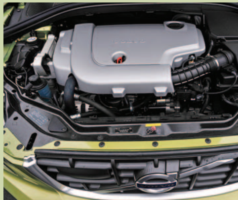
Penkių cilindrinis dyzelinis variklis toks pats kaip jo didesniojo brolio Volvo XC90
