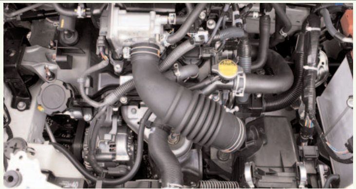
Trijų cilindrų variklis dirba ramiai ir yra pakankamai galingas, kad vežtų 890 kg svorį, tiesa jo darbo garsas yra kiek savotiškas
