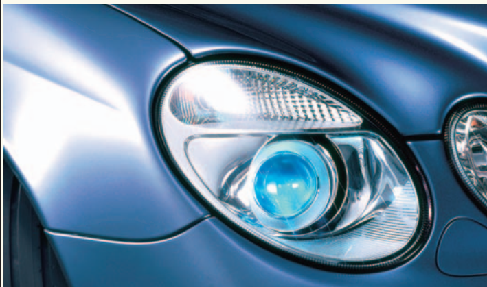
Ksenono lemputes reikia keisti poromis, nes laikui bėgant keičiasi jų techninės charakteristikos
